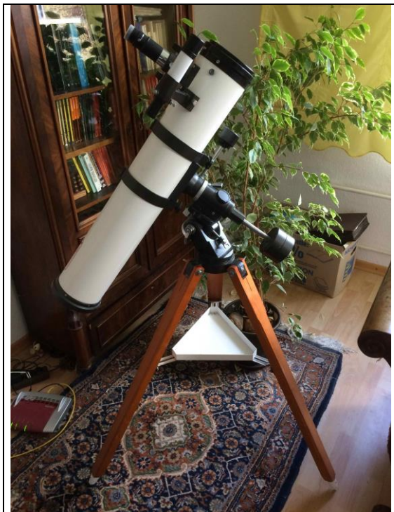
Spiegelteleskop: Tubus, Montierung und Stativ
