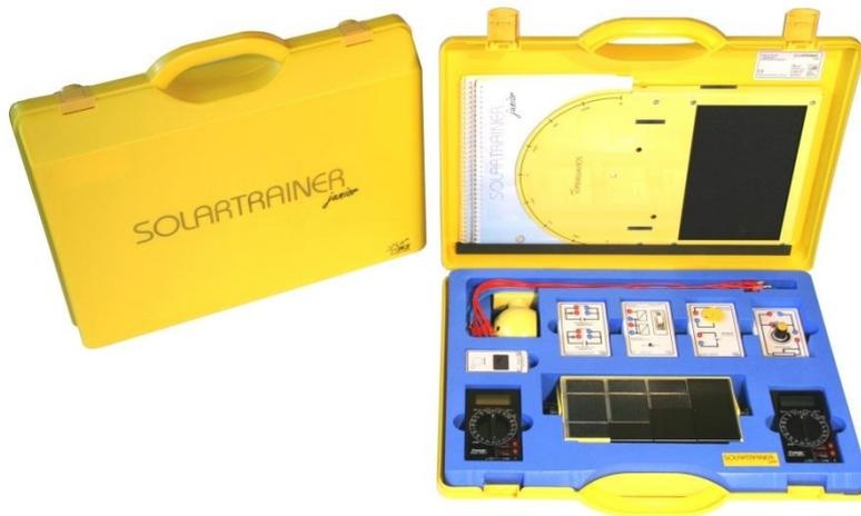
Ein einfaches Solar-Wattmeter, etwa das Gerät aus dem im Schulbiologiezentrum ausleihbaren IKS "Solartrainer" zeigt, dass eine zur Sonnenstrahlung senkrechte Fläche von einem Quadratmeter etwa 1000 Watt Leistung empfängt ( $1 \text{ kW/m}^2$ ).
